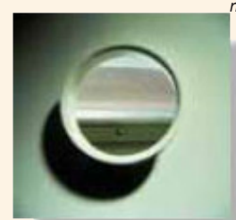
Des hublots d'inspection positionnés de manière stratégique simplifient le changement de la toile écran
