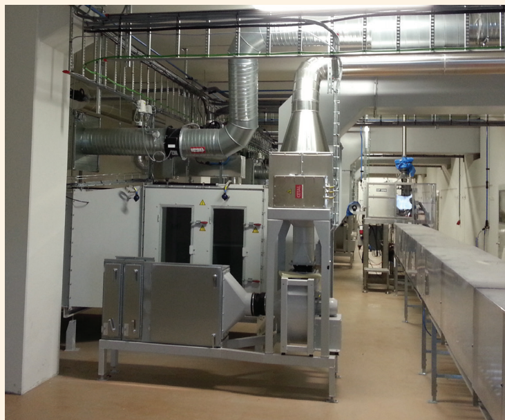
Systeme: unité de chauffe avec filtre pour presse à granuler, conditionneur LT et mélangeur à vapeur
